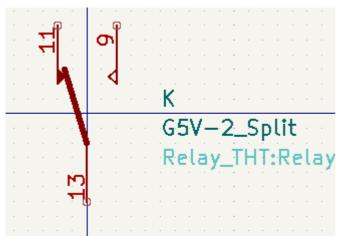
L'unità A non ha lo stesso simbolo e disposizione di pin delle unità B e C, perciò le unità non sono intercambiabili.
